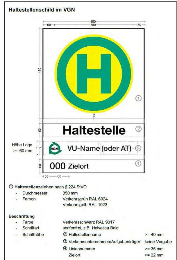
Abb. 39: Aufbau eines Haltestellenschildes nach VGN-Standard
