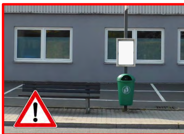
Abb. 36: Das Anbringen des Mülleimers direkt unter dem Fahrplanaushang erschwert Fahrgästen das Lesen des Fahrplans; wenn keine andere Möglichkeit gegeben ist, sollte der Mülleimer zumindest vom Fahrplankasten weggedreht montiert sein.
