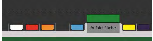
Abb. 6: Durch den Verzicht auf zwei (bis drei) Längsparkstände bietet diese Variante alle Vorteile eines Buskaps.
