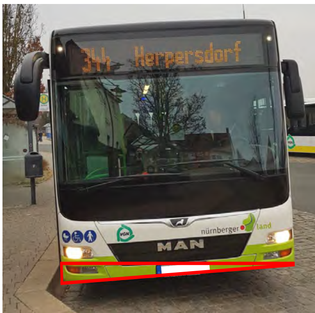
Abb. 37: Beim so genannten „Kneeling“ kann der Fahrzeugboden an der Einstiegsseite auf 27 bis 25 cm abgesenkt werden, so dass Fahrgästen das Einsteigen erleichtert wird. Beim Schließen der Türen wird der Bus wieder auf Normalniveau angehoben.
