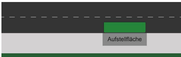
Abb. 1: Dieser Haltestellentyp kann in Abhängigkeit von der Bordhöhe und dem direkten Umfeld (keine parkenden Autos unmittelbar vor und hinter der Haltestelle) geradlinig angefahren werden.
