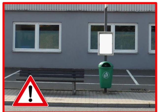
Abb. 36: Das Anbringen des Mülleimers direkt unter dem Fahrplanaushang erschwert Fahrgästen das Lesen des Fahrplans; wenn keine andere Möglichkeit gegeben ist, sollte der Mülleimer zumindest vom Fahrplankasten weggedreht montiert sein.
