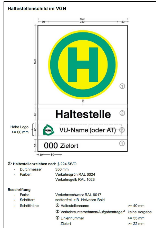
Abb. 39: Aufbau eines Haltestellenschildes nach VGN-Standard
