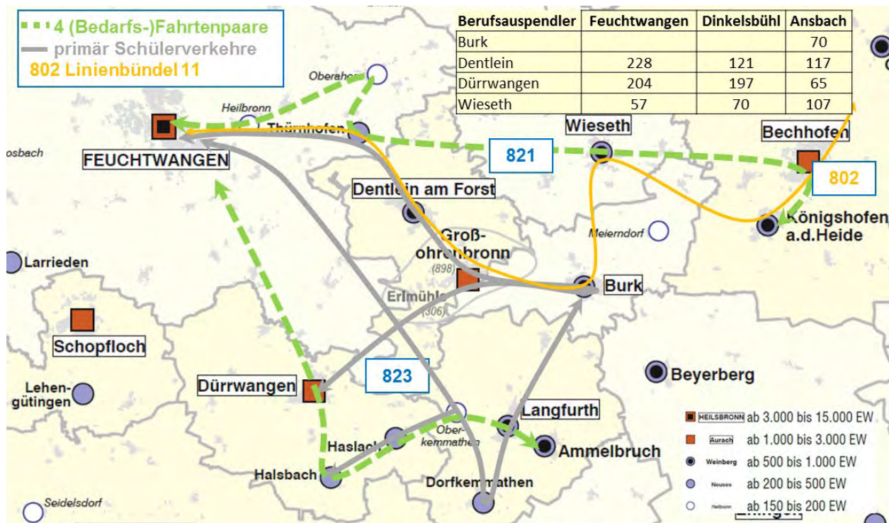
Karte 18: LB 9, Definierte Streckenabschnitte mit Linien-Nr. zur Festlegung der Bedienungshäufigkeit
