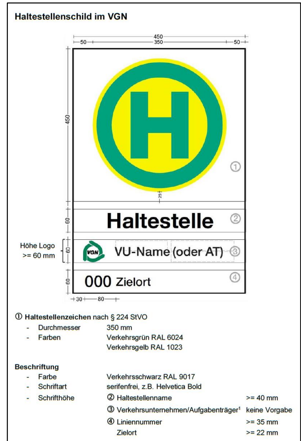
Abb. 39: Aufbau eines Haltestellenschildes nach VGN-Standard
